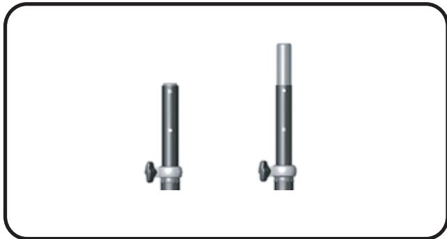
スピーカー底部のソケットの内径が 38mm (1 – 1 / 2 インチ) の場合には、付属のソケットアダプターをパイプの先端にかぶせたまま、ご使用ください。スピーカー底部のソケットの内径が 35mm (1 – 3 / 8 インチ) の場合には、付属のソケットアダプターをはずした状態で、パイプをスピーカーソケットに差し込み載せてください。
