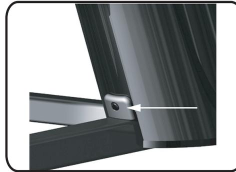
大型で重量が重いキーボード又は全体的に位置を低くするためには図のアンクル・アダプターを取り外し、角度を変えます。
