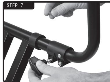
Zノブ、ワッシャー、ヘックス・ナットを取り付けます。このとき、ハンドノブのつまみ部が必ず内側を向くように取り付けます。逆に付けると完全に折りたためなくなります。また、きつく締めすぎないように気を付けてください。きつく締めすぎるとプラスチックパーツが割れる恐れがあります。
